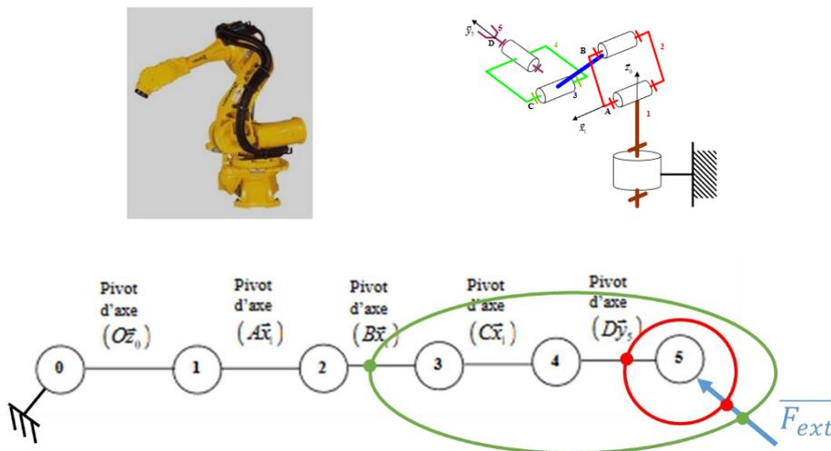
Isolement **rouge** : Détermination des efforts dans la liaison pivot d'axe  $(D, \vec{y}_5)$ .
