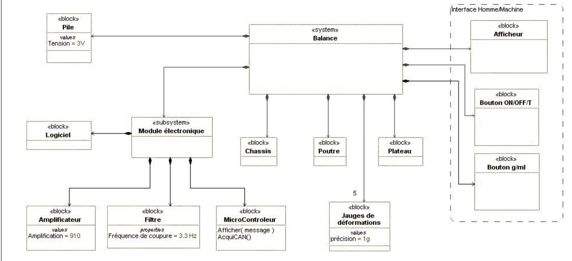
La mesure est effectuée à l'aide de jauge de déformation qui mesurent une déformation et en déduisent le poids mesuré.
