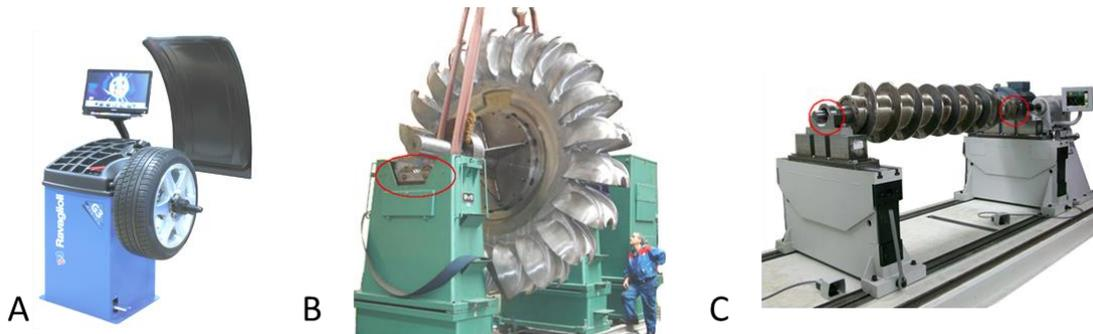
A- Equilibreuse garage (roue de véhicule). B - Equilibreuse spéciale (Turbine Pelton) – zone entourée : palier instrumenté.
