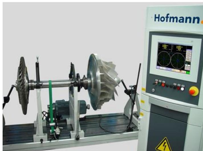
En équilibrant, on vérifie l'écart entre l'axe d'inertie et l'axe de rotation. Puis si nécessaire la répartition des masses autour du mobile en rotation est modifiée par un équilibrage, de telle sorte que les forces engendrées par le balourd et les vibrations restent dans des limites autorisées
