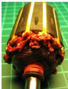
*Encoches usinées permettant de réaliser l'équilibrage statique et dynamique du rotor*
