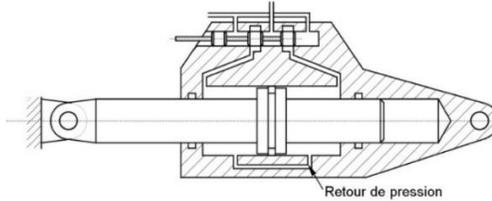
Ce dispositif est constitué d'une canalisation de petite section qui relie les deux chambres du vérin. Il permet de « compenser » le débit d'huile introduit par le distributeur au cours d'un dépassement de position (oscillation).
