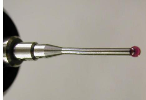
Pour mesurer l'état d'une surface d'une pièce ou pour vérifier la précision d'un usinage réalisé sur une pièce (précision jusqu'au  $\mu\text{m}$ ), l'utilisation d'un Machine à Mesurer Tridimensionnelle (MMT) est nécessaire. Une MMT permet d'obtenir les coordonnées des points mesurés (palpés) sur une pièce mécanique.
