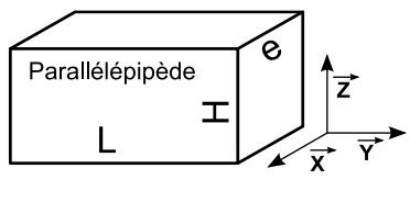
*Deux Plans de symétrie ( $Q, \vec{x}, \vec{y}$ ) et ( $Q, \vec{x}, \vec{z}$ ) :*
