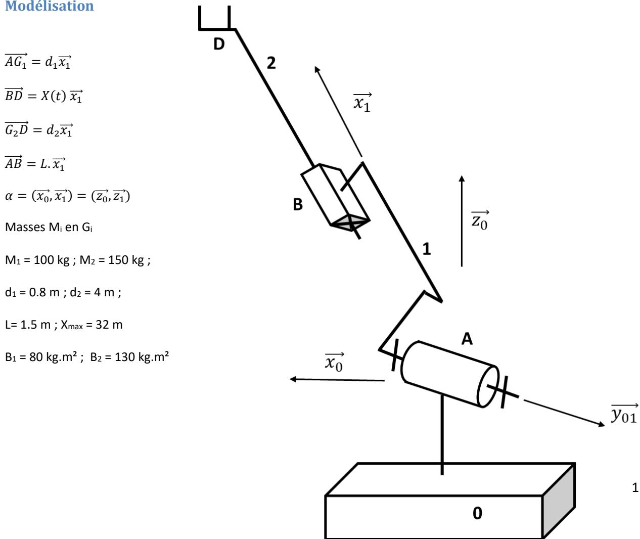
**Objectif du TD : Dimensionner les actionneurs du système de déplacement de l'échelle.****Questions**
