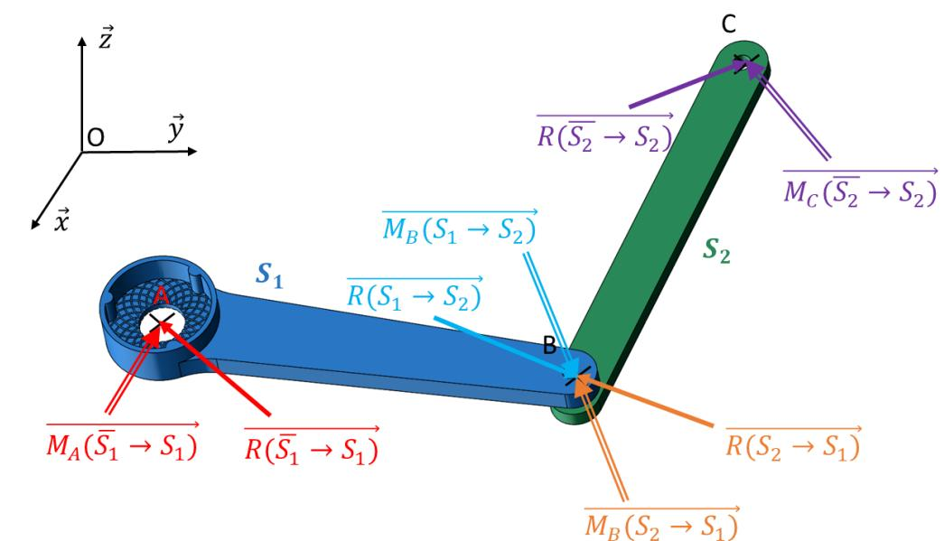
Conclusion : Quand on isole un ensemble de solides  $\Sigma$ , et que l'on applique le PFD, on s'intéresse uniquement au bilan des actions mécaniques extérieures à  $\Sigma$ .
