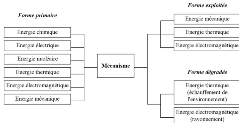
Le rendement mécanique d'un mécanisme est donné par :  $\eta(t) = \frac{|P_{réceptrice}|}{P_{motrice}}$
