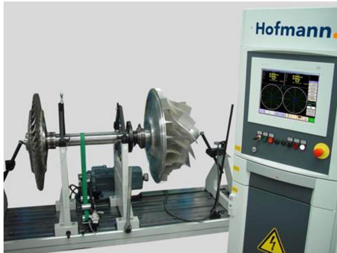
En équilibrant → Vérifie l'écart entre l'axe d'inertie et l'axe de rotation.
