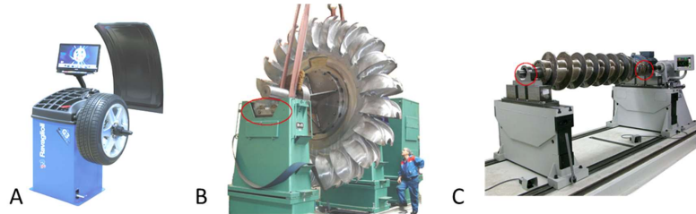
A - Equilibreuse garage (roue de véhicule). B - Equilibreuse spéciale (Turbine Pelton) – zone entourée : palier instrumenté. C - Equilibreuse universelle (vis de forage) – zones entourées : paliers instrumentés.
