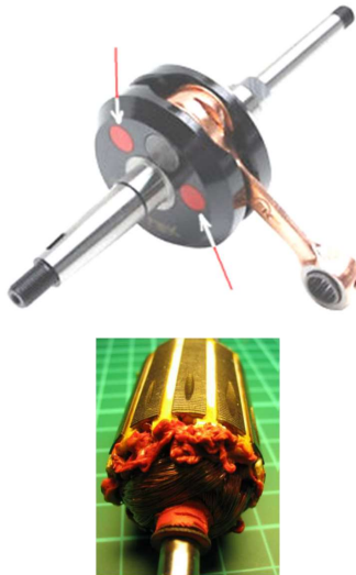
Encoches usinées permettant de réaliser l'équilibrage statique et dynamique du rotor
