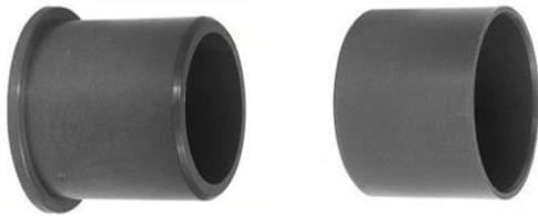
Il s'agit d'une pièce d'usure qui possède un coefficient de frottement moins important que celui d'un contact direct et que l'on place entre les deux solides. On trouve classiquement des paliers en bronze, laiton, PTFE (plastique anti-adhérent). Ils permettent d'obtenir un mouvement relatif entre deux solides modélisable par une liaison **pivot** ou **pivot glissant**.
