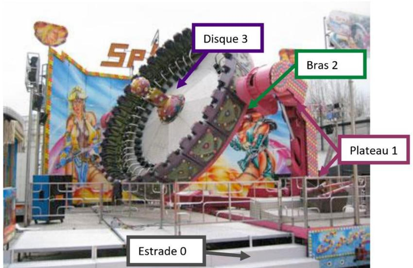
La position du point D du disque 3 est défini par :  $\vec{BD} = c \cdot \vec{x}_3$  (avec c constant).
