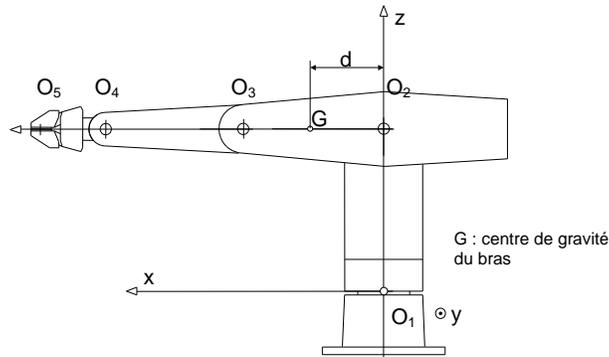
Nous allons mesurer l'intensité du moteur pour les deux sens de rotation et pour plusieurs charges placées dans la pince du robot, en se limitant à des mouvements autour de la position horizontale.
