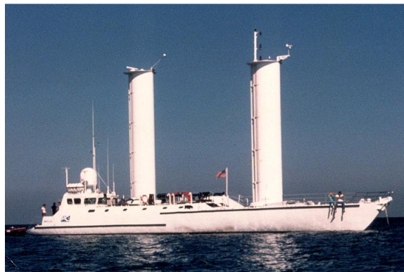
Figure 1 : L'Alcyone est équipé de deux turbovoiles
