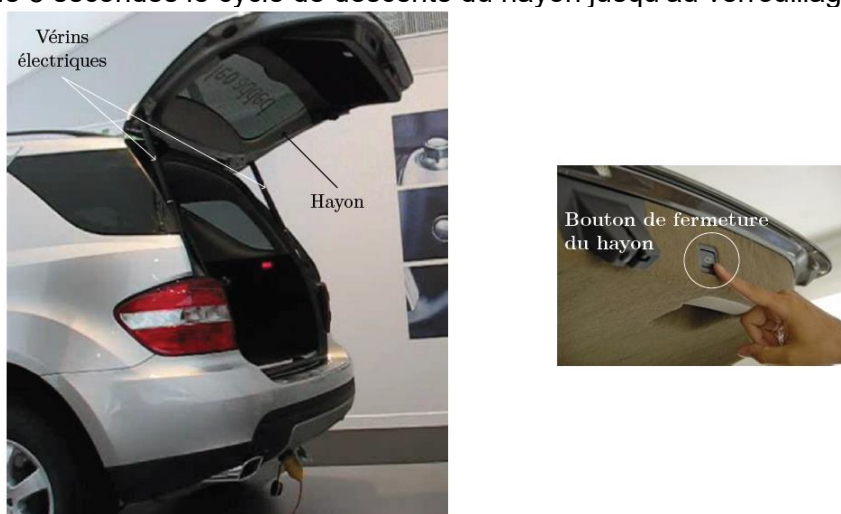
Figure 1 Description d'un hayon
