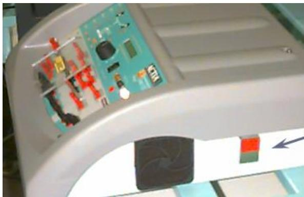
Pour allumer la DAE, appuyer sur le bouton vert situé sur le côté du système
