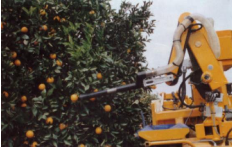
Figure 1 : Robot cueilleur de fruit, dont est extrait le bras articulé Maxpid.
