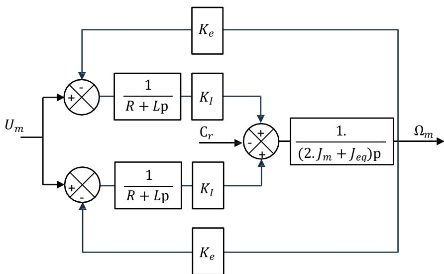
$J_{eq}$  est l'inertie équivalente de la tourelle (2) incluant la transmission et le canon (3) du point de vue des moteurs.
